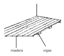
Asigne este código al piso construido con tablas unidas entre sí (machihembra) de 10 a 15 cms. de ancho. Están clavadas sobre vigas, tacos de madera y/o cimientos, soleras.
