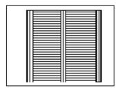
Asigne este código a los muros de poco espesor (unos 10 cms.) cuya firmeza la da una estructura de madera (pies derechos, soleras). Esta estructura va recubierta enteramente por madera, tejuela, zinc, pizarreño, etc., sólo por el exterior.
