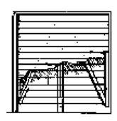
Asigne este código a los muros de poco espesor (unos 10 cms.) cuya firmeza la da una estructura de madera (pies derechos, soleras).
